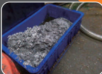
走心式車床 油性底屑
