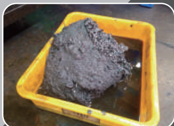
CNC銑床油性 陳年底泥與鐵屑
